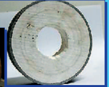
Dépôts sur tuyaux métal ou plastique
